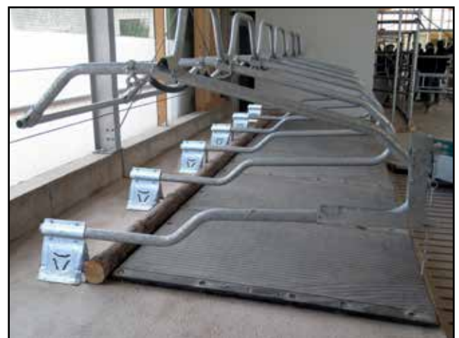
Liegebox "Relax" mit gekröpftem Nackenrohr, Nackenkette mit Kunststoffrohr und Bodenkonsole
