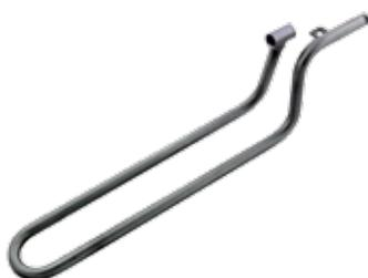
Durchlaufrohr 3/4" aus Edelstahl zum Einbau in alle Flachschenkträge mit MASTER-FLOW-Schwimmerventil geeignet. Durch Anschluss an eine Ringleitung mit einem Heizgerät wird ein Frostschutz sowohl für die Leitung als auch für das Wasser in der Tränkewanne erreicht.
