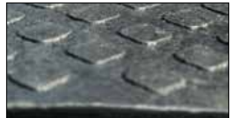
gewölbte Oberfläche mit Quadratprägung
