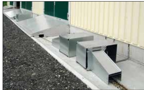
Antriebswinde EW4 und Querkanalabdeckung
