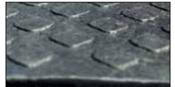
gewölbte Oberfläche mit Quadratprägung
