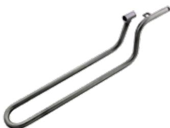
Durchlaufrohr 3/4" aus Edelstahl zum Einbau in alle Flachschwenkträge mit MASTER-FLOW-Schwimmventil geeignet. Durch Anschluss an eine Ringleitung mit einem Heizgerät wird ein Frostschutz sowohl für die Leitung als auch für das Wasser in der Tränkewanne erreicht.
