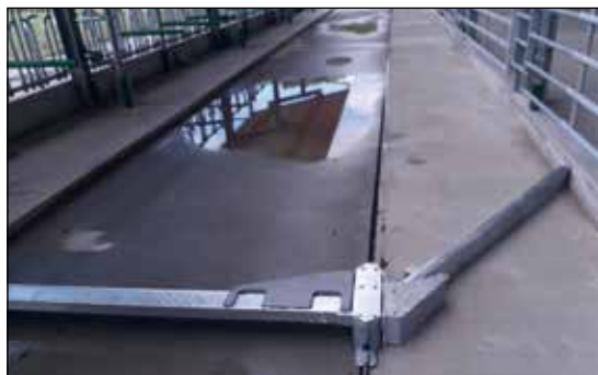
Pendelklappschieber für Tretmist
