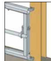
Mittleres Rohr in der unteren Position
