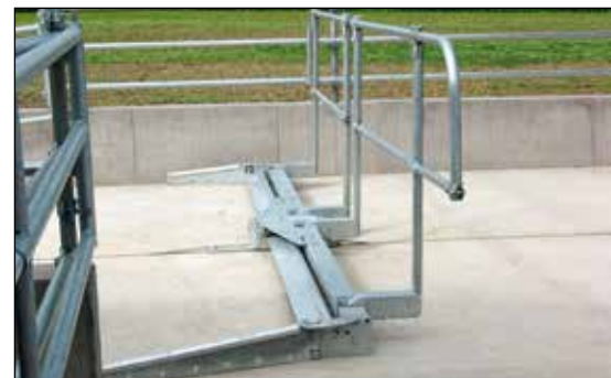
Pendelklappschieber PKSf mit Treibgatter
