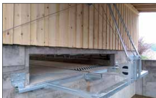
Klappbarer Ausleger für tieferliegende Dungelege
