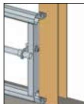
Mittleres Rohr in der Mittelposition
